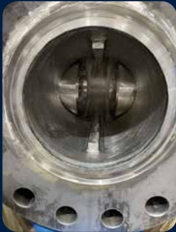
•Válvula de compuerta revestida de Inconel
